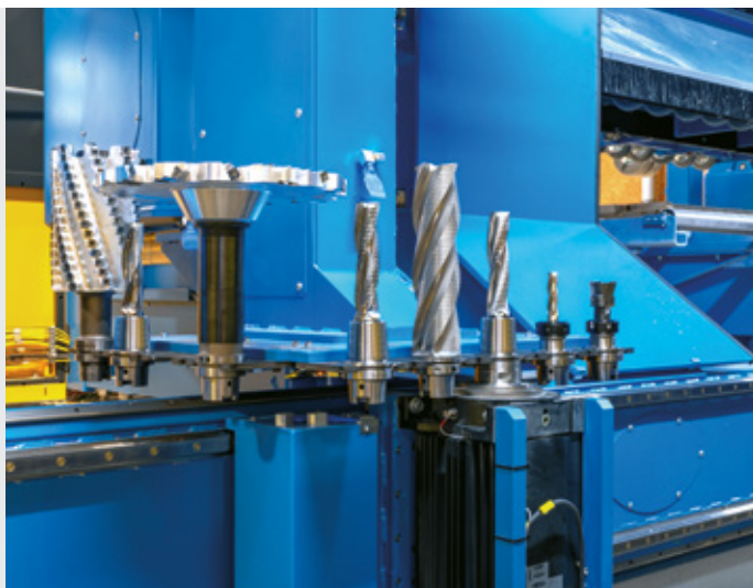
Die Basisbevorratung des PBA-Drive Werkzeugmagazins bietet Platz für bis zu 26 Werkzeuge.
