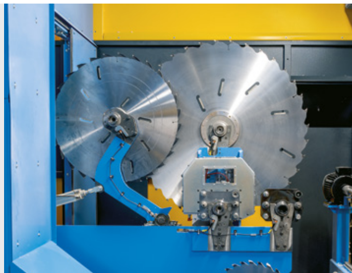
Das Magazin mit vier Werkzeugfächern ermöglicht dem 5-Achs-Aggregat direkten Zugriff auf Spezialwerkzeuge für anspruchsvolle Bearbeitungen.
