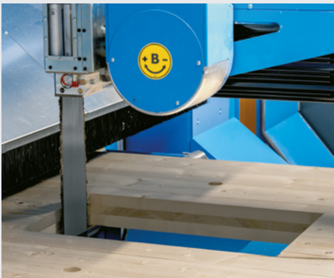
Das 5-Achs-Kettensägenaggregat fertigt Schlitzte oder Eckenfreistiche bis zu einer Schlitztiefe von 520 mm.
