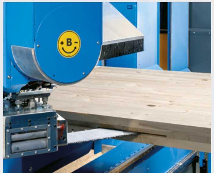
Das 5-Achs-Kettensägenaggregat fertigt Schlitzte oder Eckenfreistiche bis zu einer Schlitztiefe von 520 mm.
