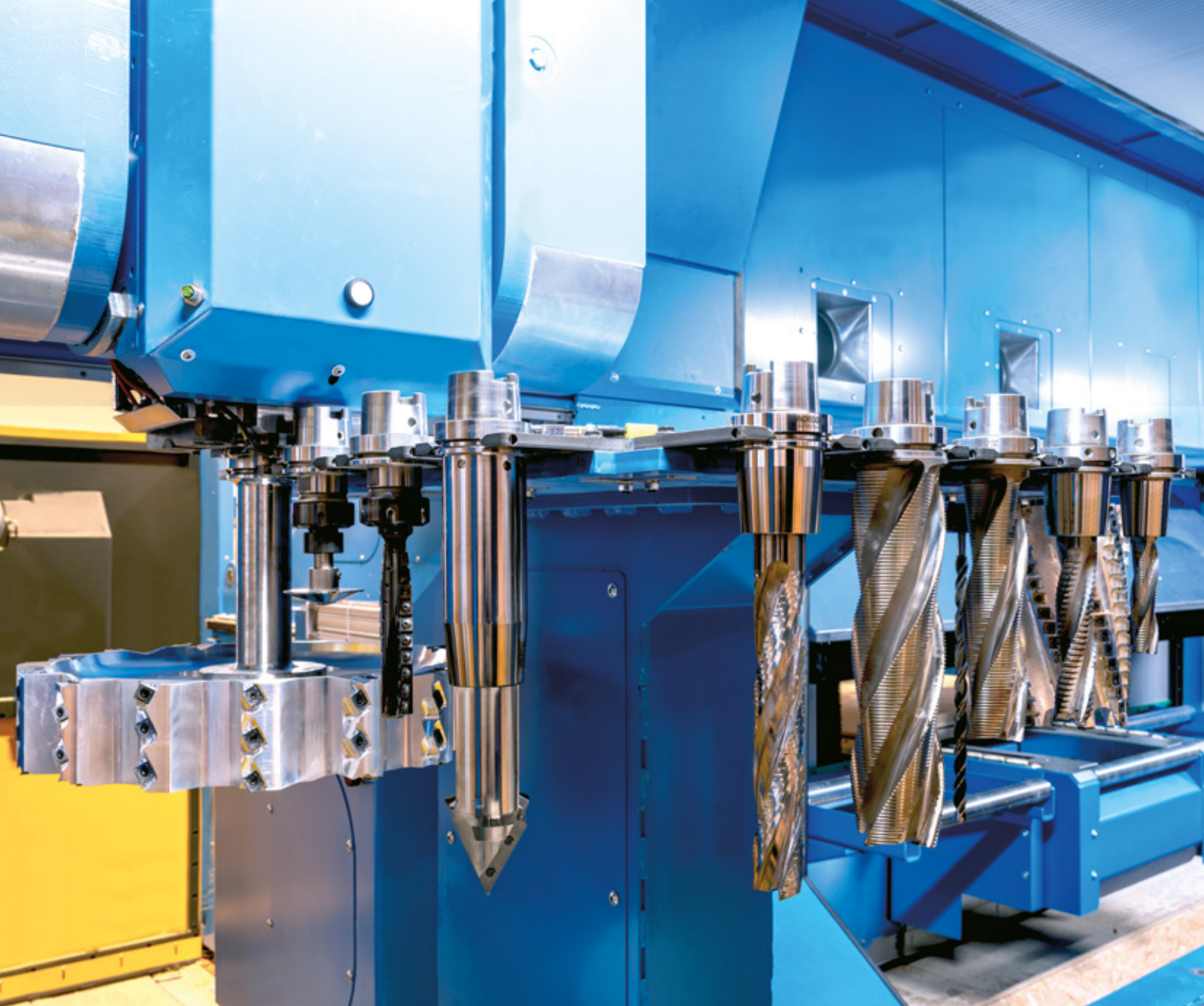
Werkzeugmagazin für automatischen Werkzeugwechsel mit 26 Werkzeugfächern.
