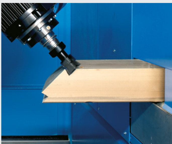
Spoj typu „vlaštovčí ocas“ na posuvném stroji
