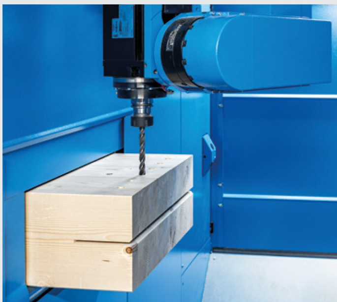
Vrtání bez vytrhávání materiálu ve spoji s drážkováným plechem
