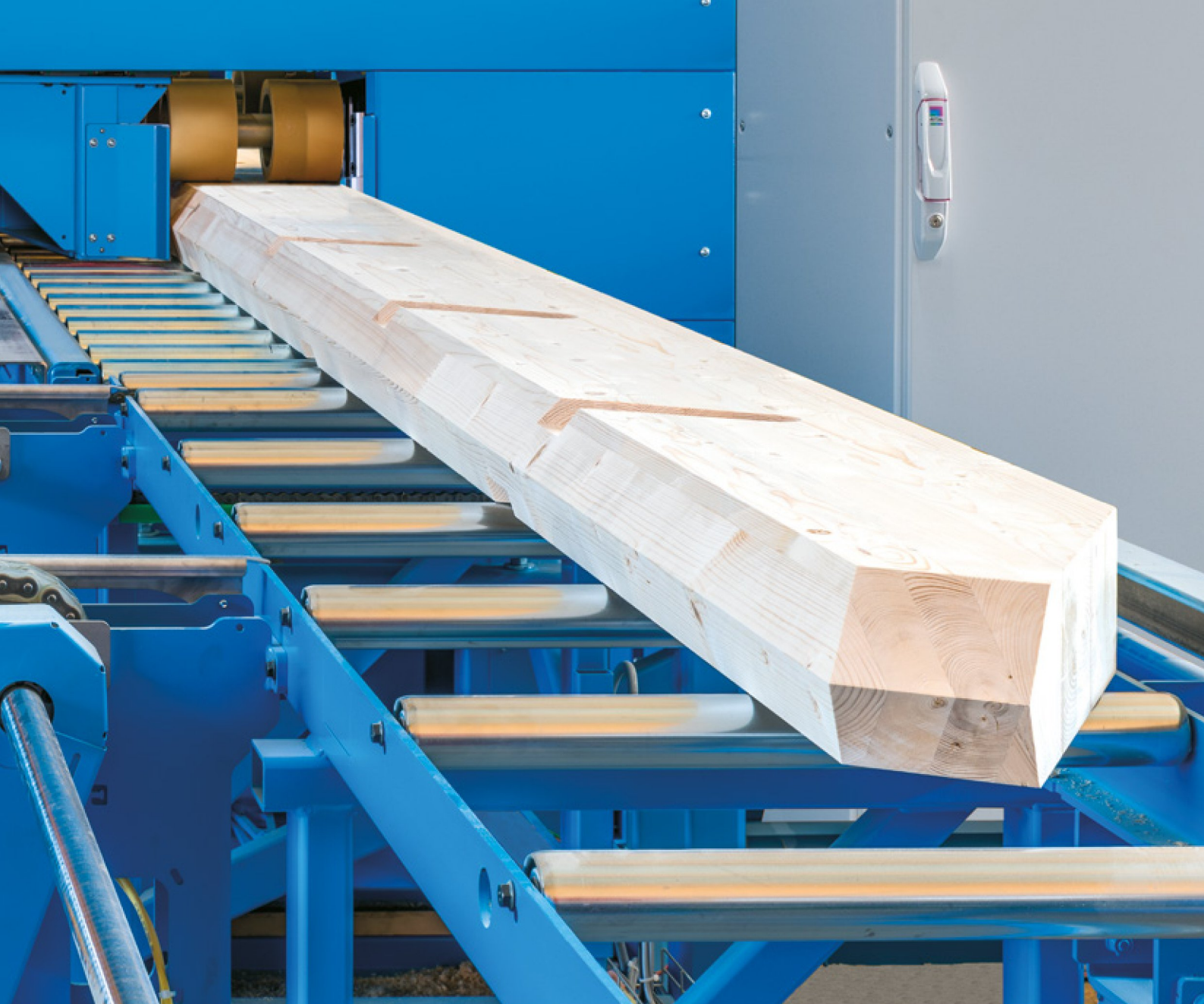
Hřebenové trámy s otvory pro čepy typu „vlaštovčí ocas“
