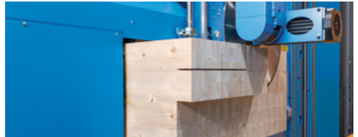
Segmentieren mit Kreissäge-Aggregat.
