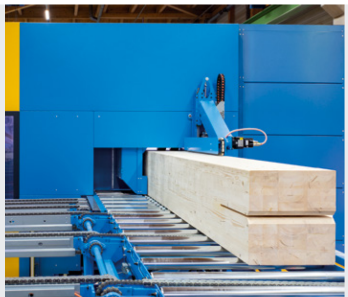
Alternative Ausförderung auf einen Kettenförderer.
