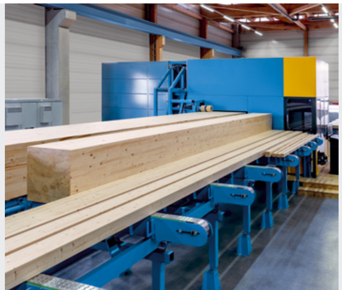
Vollautomatische Beschickung – unabhängig vom Querschnitt.
