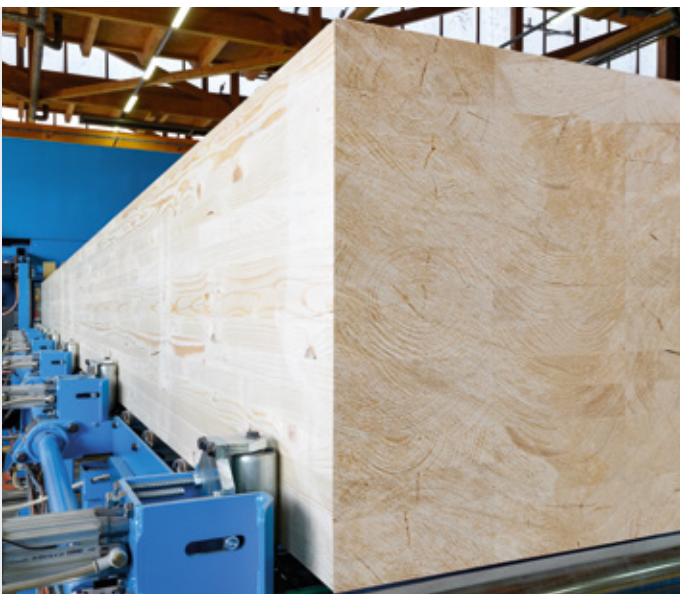
Automatische Ausrichtung auch größerer Hölzer an der O-Linie.
