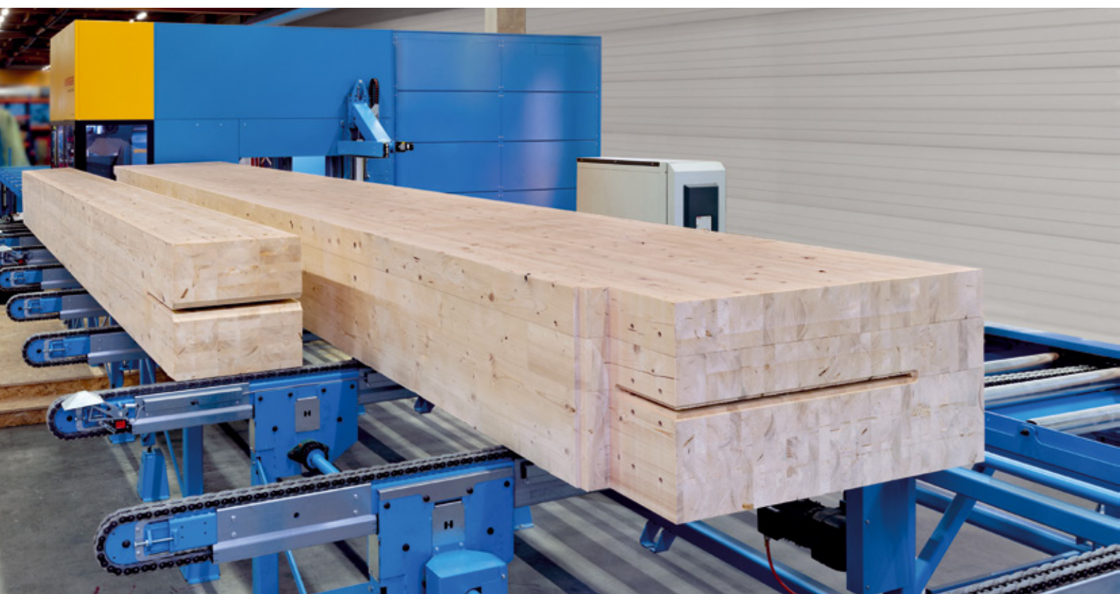
Segmentieren mit Sägeblatt in ROBOT-Aggregat.
