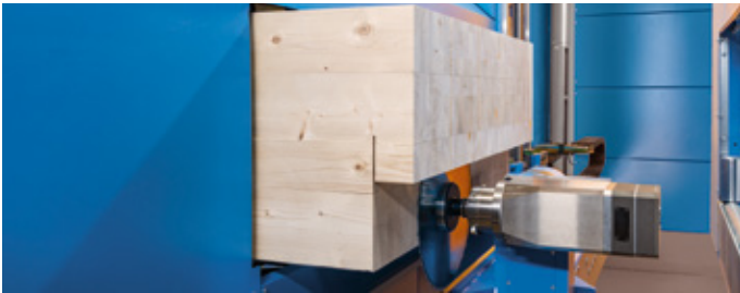
Segmentieren mit Sägeblatt in ROBOT-Aggregat.
