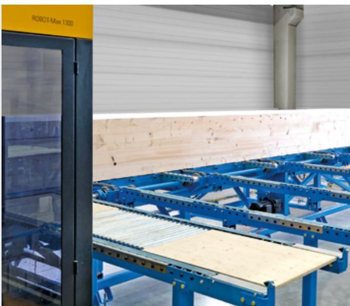
Ausförderung auf Ablageböcken mit Rollen.
