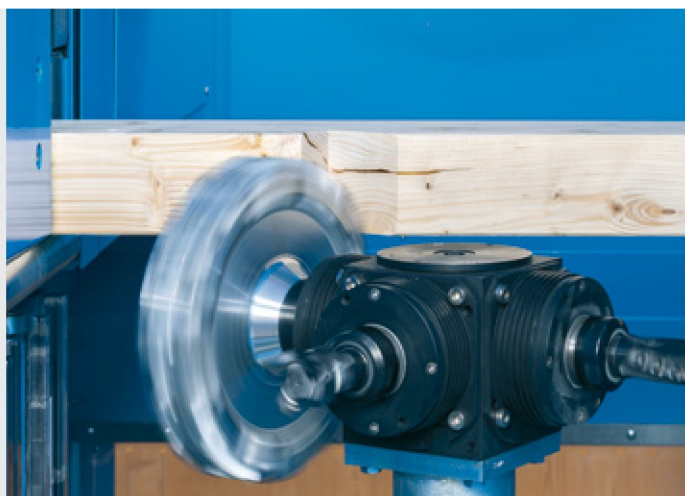
Zářezy lze frézovat efektivně – bez vytrhávání materiálu.
