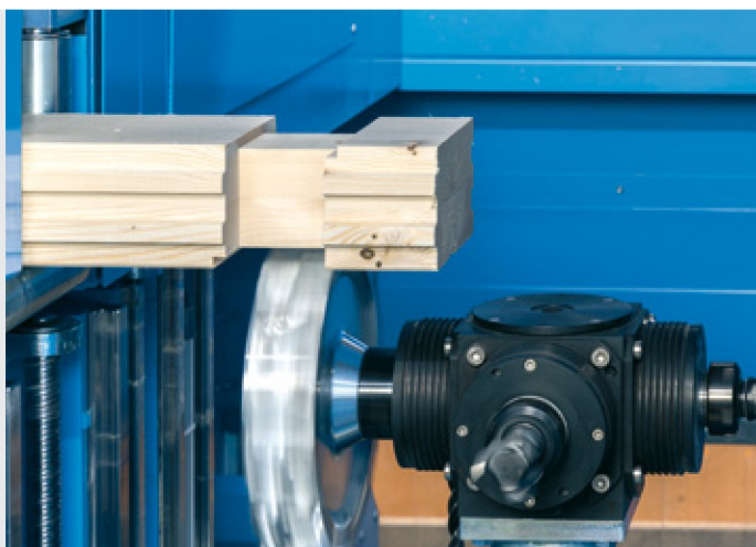
Vyfrézování je možné na všech 6 stranách dílu.
