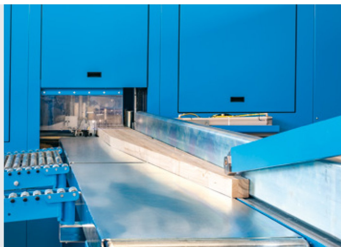
Řízený transport obrobků pomocí stabilního vozíku s chapadly.
