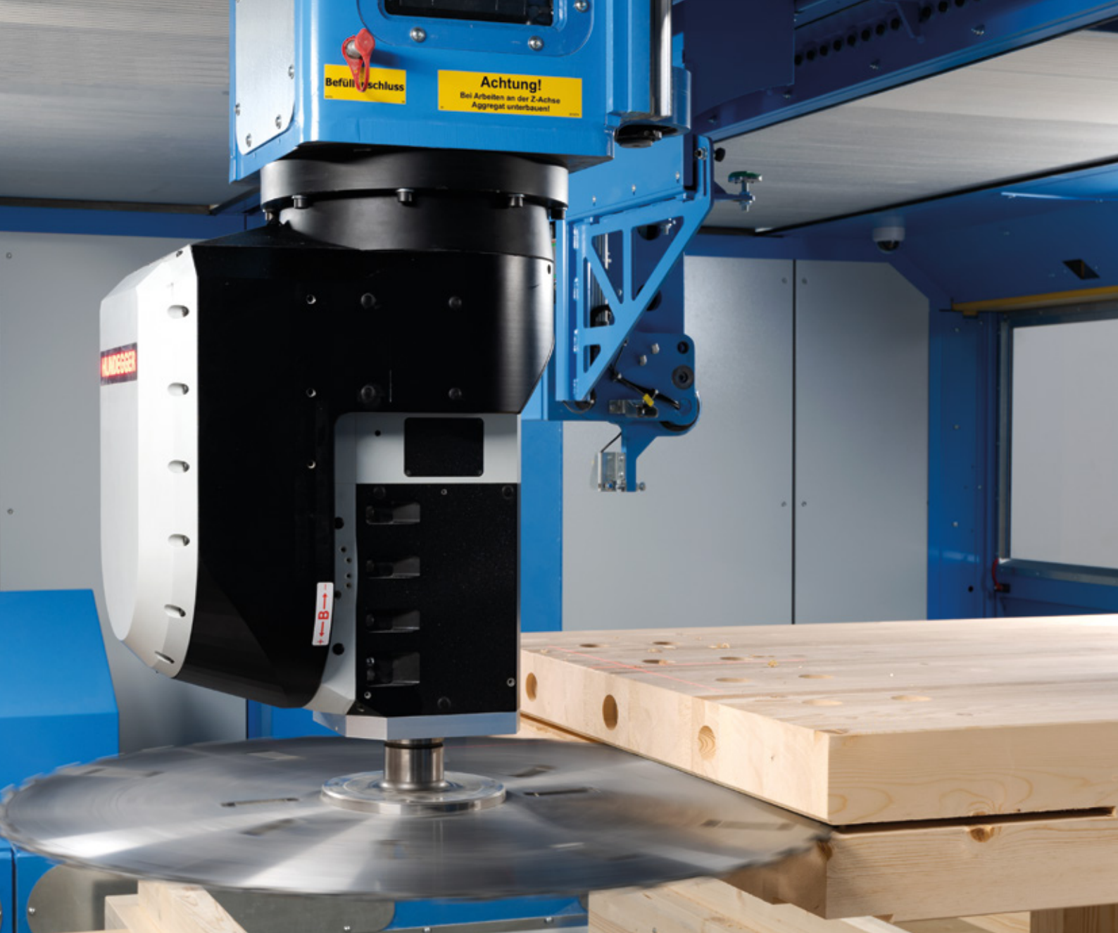
5osý agregát 35 kW s plynule regulovatelnými otáčkami od 0 do 12 000 ot/min
